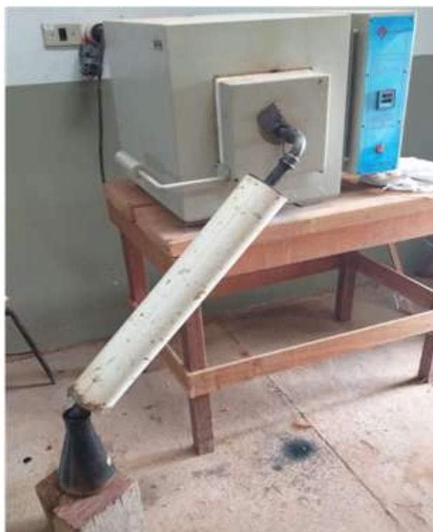
Figura 2 – Processo de carbonização no forno mufla. Fonte: Autor
