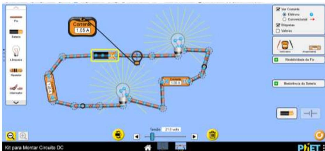
**Figura 6:** Circuito simples com vários medidores de unidades elétricas Amperímetros; Resistores (Lâmpadas); chaves (interruptor) e Fonte (Bateria).
