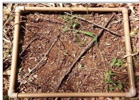
Figura 3. Gabarito constituído de policloreto de polivinila (PVC) de 50 por 50 cm (0,25 m 2 ) utilizado na coleta da serapilheira acumulada na região de Aquidauana, MS.
