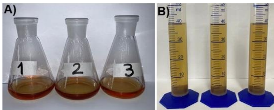
Figura 1. Imagens das análises de méis de Apis mellifera produzido em Nova Olímpia-MT. A) Lugol e B) Lund.
